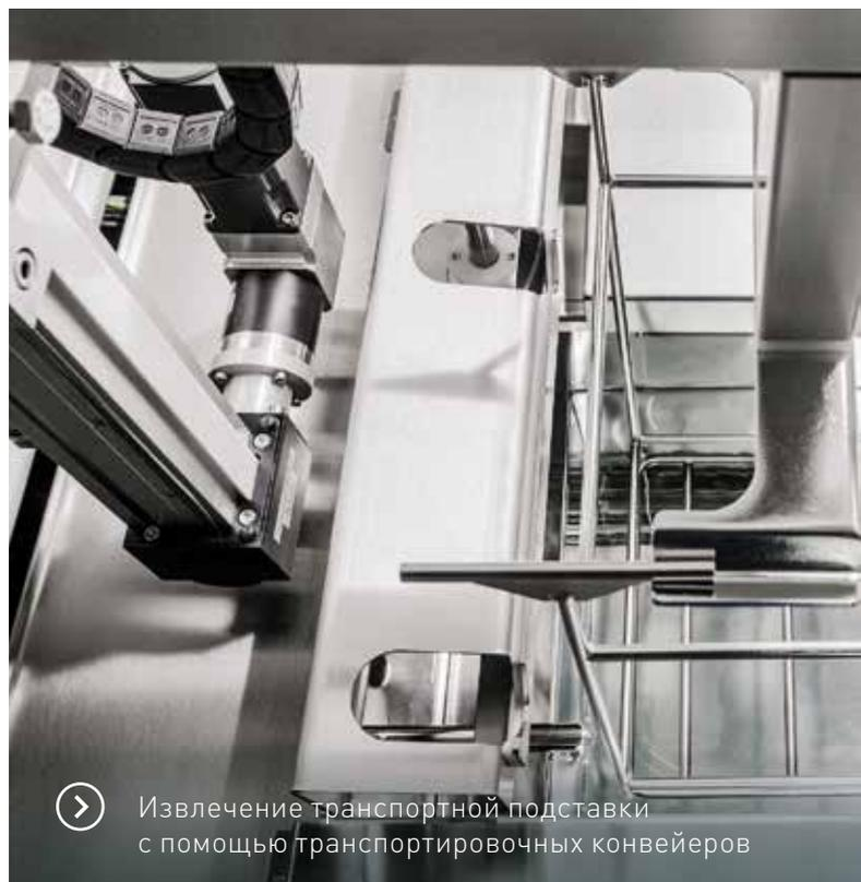
➤ Извлечение транспортной подставки с помощью транспортировочных конвейеров
